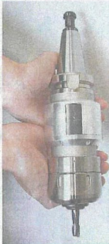
山本金属製作所岡山研究開発センターが開発したドリルの振動計測装置
