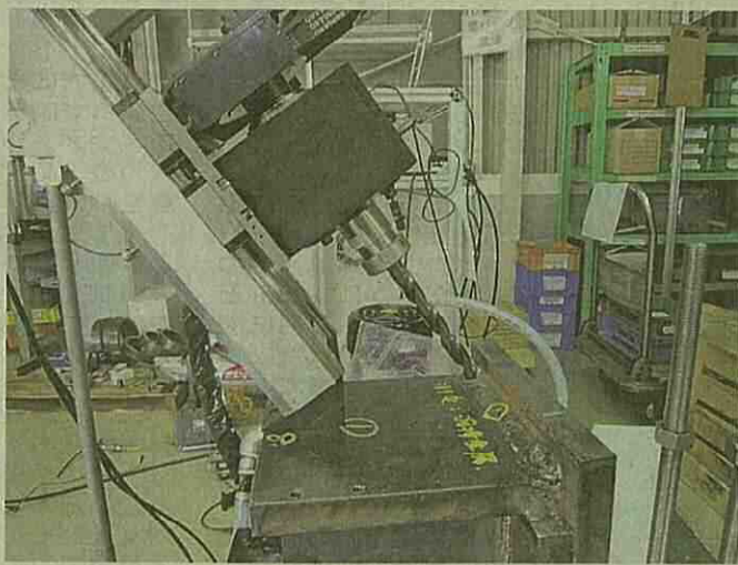
残留応力を計測するためサンプルに穴を掘る加工機
